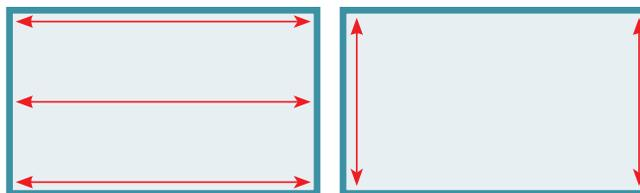
Mesurer la largeur et la hauteur aux endroits indiqués par les flèches.
