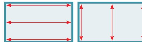
Mesurer la largeur et la hauteur aux 3 endroits indiqués par les flèches.
