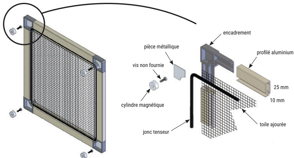
*Produit fabriqué sur-mesure, prêt à assembler*
